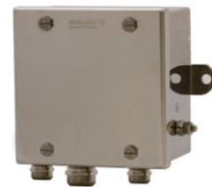
L'EOL de Patol, équipé d'interrupteurs de test pour les incendies et les défauts, peut être installé à un emplacement pratique, soit en haut d'une échelle d'accès au réservoir, soit au niveau du sol à l'extérieur du réservoir. Cela permet d'effectuer la maintenance et les tests de routine de l'ensemble du système jusqu'à la salle de contrôle.
